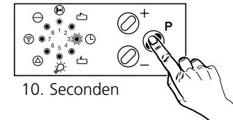
(Bij aktivering van de functie automatisch sluiten moet een externe fotocelbeveiliging aangesloten worden (b.v. Special 613/614) en overeenkomstig geactiveerd worden. Anders is automatisch sluiten niet mogelijk.)
